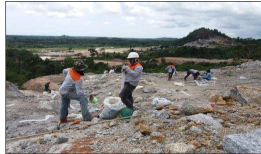
Gambar 5. Kegiatan pengisian bahan peledak PT Vitrama Properti
