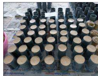
Gambar 1. Cetakan silinder semen
