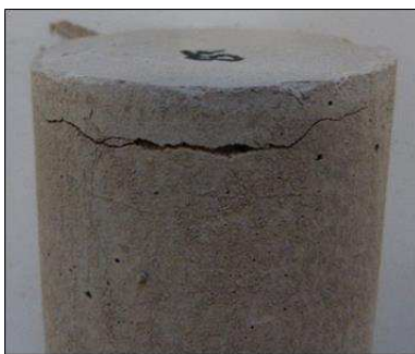
Gambar 8. Sampel retak pada suhu 600°C
