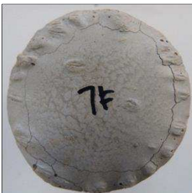
Gambar 8. Sampel retak pada suhu 600°C
