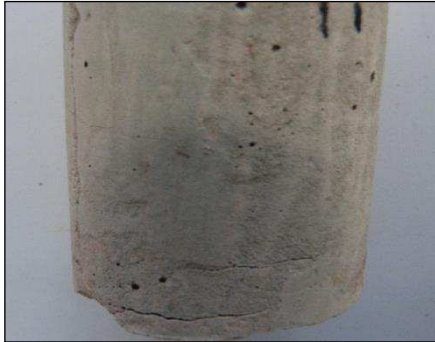
Gambar 12. Sampel retak pada suhu 900°C
