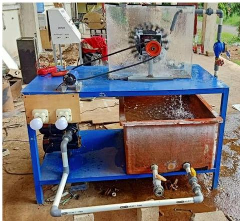
Gambar 2. Prototipe PLTMH Menggunakan Turbin Pelton
