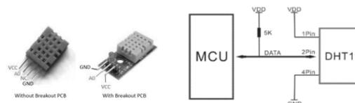
**Gambar 7.** Sensor suhu dan kelembaban DHT11 (Syam, 2013)
