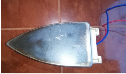
Gambar 3.1 : Sumber pemanas sisi panas peltier
