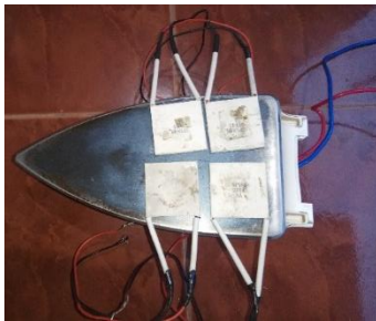
Gambar 3.2 : Peletakan peltier diatas pemanas
