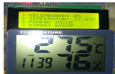
Gambar 3.3 Pengujian Sensor LM35 dan Termometer (sumber: perancangan)
