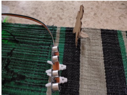
Gambar 4.2. Pengujian Ultrasonic Sensor HC-SR04 Pada Sistem Lampu Otomatis
