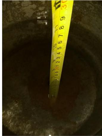
Gambar 3 Pengukuran tinggi air
