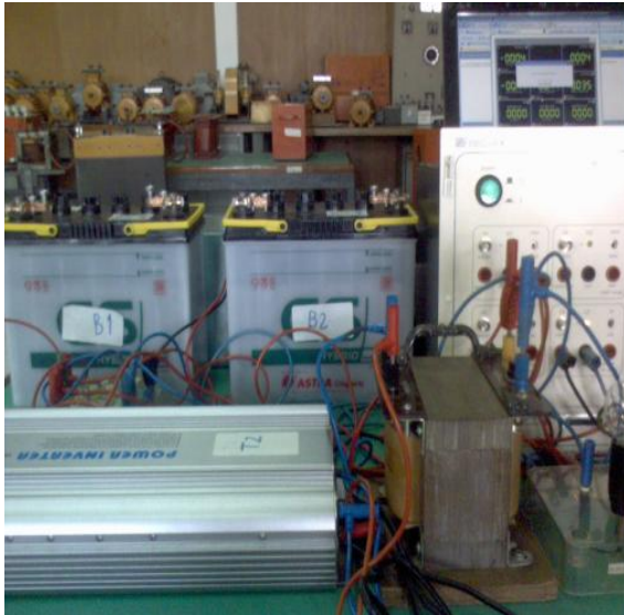
Gambar 4b. Pengujian jaringan listrik mikro
