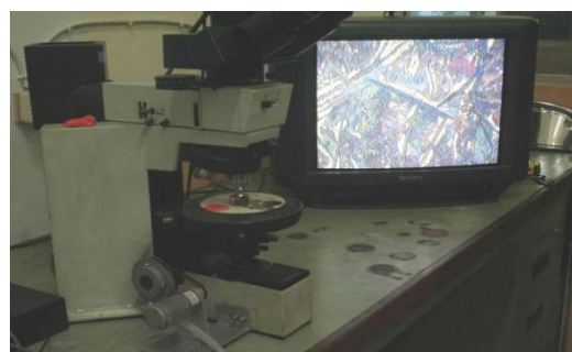
Gambar 8. Metode pengambilan data teknologi lama (Gambar yang diambil dari kamera ditampilkan langsung pada layar TV).
