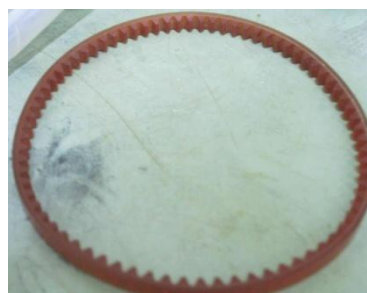
Gambar-4. Belt kopling motor dc ke kenop mikroskop.
