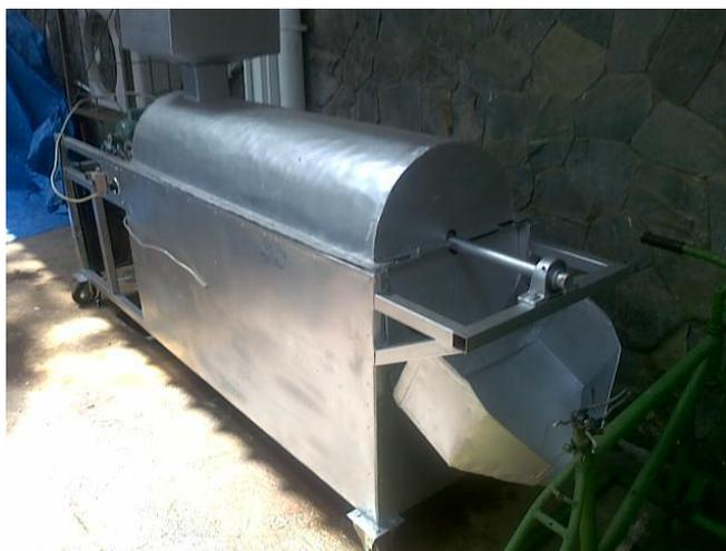
Gambar 1. Alat Pengering Gabah Kontinyu kapasitas 60 kg
