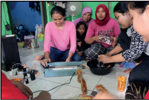
Gambar 7. Proses Perekatan Kemasan dengan Impulse Sealer
