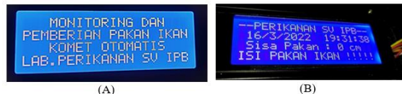
Gambar 9. Tampilan LCD (A) alat baru terhubung (B) informasi waktu, persediaan pakan, dan notifikasi
