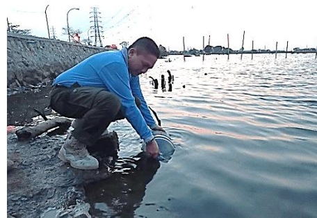
Gambar 3. Proses Pengambilan Media Air Laut Untuk Perendaman
