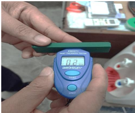
Gambar 4. Proses Pengukuran Ketebalan Lapisan Cat
