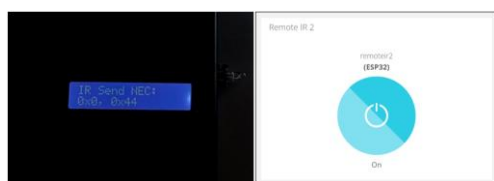
Gambar 6. Tampilan pada gateway (kiri), tombol pada Ubidots (kanan) saat tombol Remote IR 2 ON
