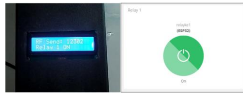
Gambar 3. Tampilan pada gateway (kiri), tombol pada Ubidots (kanan) saat tombol Relay 1 ON
