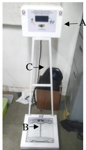
Gambar 10. Realisasi Mekanik Keseluruhan Realisasi mekanik merupakan wujud dari mekanik yang telah dirancang lalu dibuat dalam bentuk yang nyata. Realisasi mekanik ini terdiri dari realisasi box mikrokontroler (A), realisasi mekanik timbangan (B) dan realisasi tiang penyangga (C).
