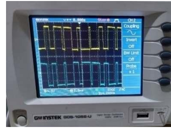
Gambar 12. Bentuk Gelombang Keluaran Modul Pemisah Polaritas dengan Frekuensi Carrier 314 Hz
