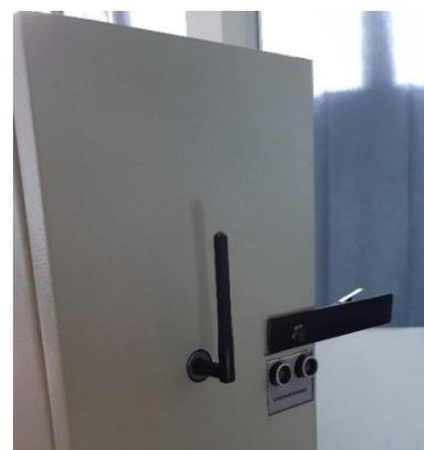
Gambar 5.1 Sensor Ultrasonik, antena dan limit switch bawah
