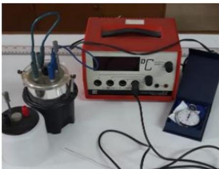
Gambar 1. Peralatan Percobaan Penentuan Kalor Lebur Es
