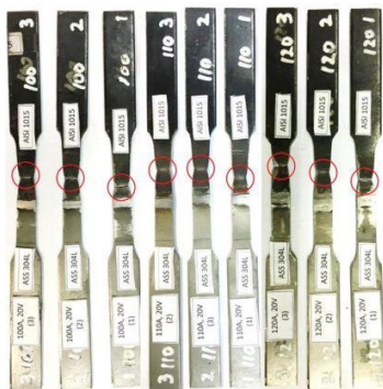
Gambar 14. Posisi patahan hasil uji tarik
