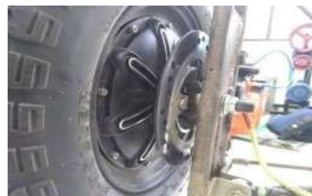
Gambar 10. Pengecekan bantalan motor listrik
