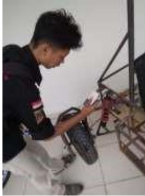
Gambar 11. Pengecekan suhu motor listrik
