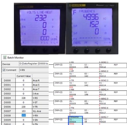
Gambar 9. Hasil pengujian komunikasi PLC – PM
