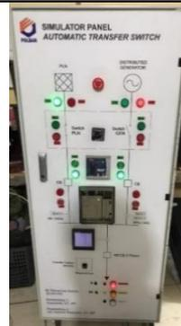
Gambar 11. Pengujian sistem SCADA pada simulator panel ATS
