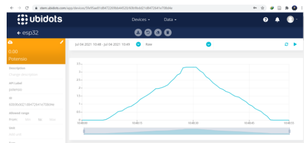
Gambar 9. Hasil pembacaan nilai pada ubidots dari ESP32 menggunakan potensiometer secara grafik
