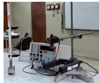
Gambar 1. Perangkat alat eksperimen modul Gerak Jatuh Bebas
