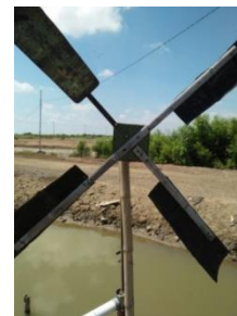
Gambar 1. Kincir angin dengan blade drum bekas
