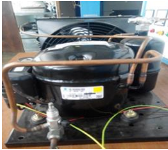
Gambar 5. Condensing unit dengan spesifikasi: Hermetic comp. AE 1390Y.
