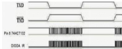
Gambar 5. Bentuk Modulasi Infra Merah
