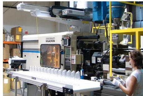
Gambar.1 Mesin Injeksi Molding [7]
