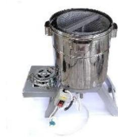
Gambar 2. Mesin Spinner Peniris Minyak
