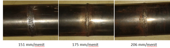
Gambar 4. Spesimen uji kecepatan 151, 175 dan 206 mm/menit
