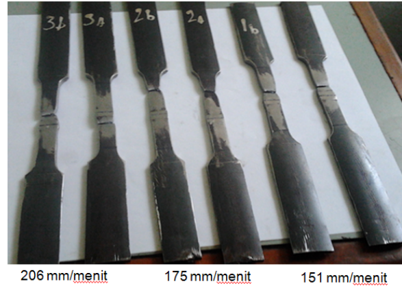
Gambar 10. Posisi patahan hasil uji tarik
