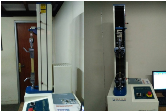
Gambar 7. Posisi Spesimen Pada Mesin Uji Tarik
