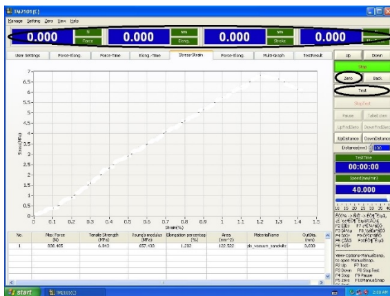
Gambar 8. Tampilan Software Uji Tarik (TM2101) Siap Uji
