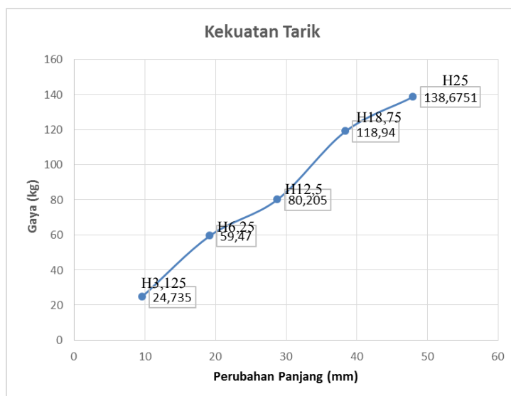
Gambar 9. Grafik Perbandingan Hasil Pengujian Kekuatan Tarik Hidrogel Crosslinked Karaginan dengan Variasi Jumlah Konsentrasi Crosslinker
