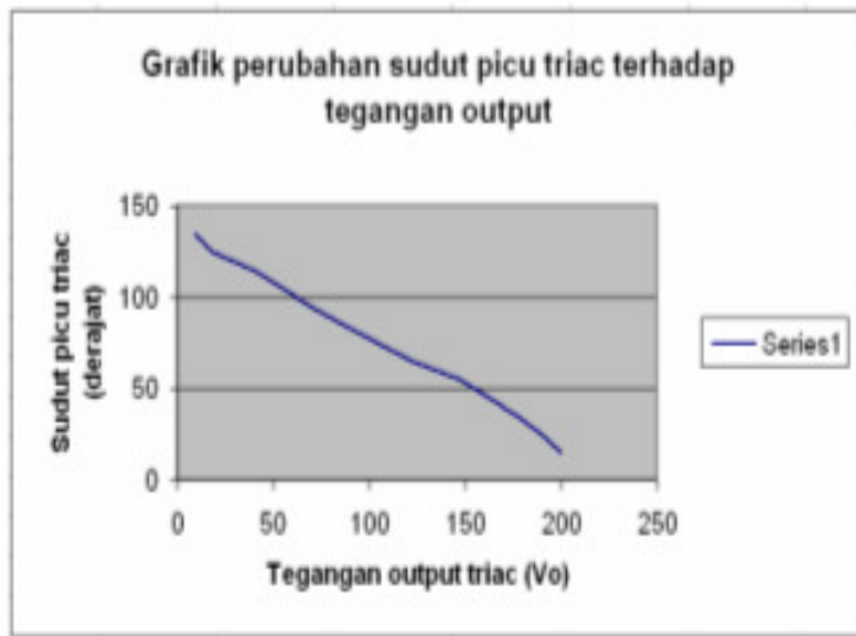
Gambar 3. Grafik dengan beban lampu pijar dengan spesifik 220V/5W.
