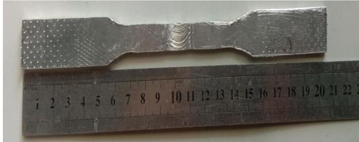
Gambar 5. Spesimen tarik *feed rate* 42 mm/menit Al 7075
