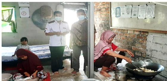
Gambar 3. Proses produksi pengirisan keripik tempe dengan cara manual
