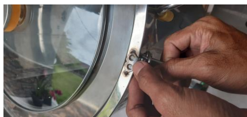
Gambar 2. Proses perakitan terakhir pemasangan tutup wadah
