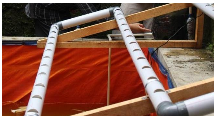
Gambar 8. Pelubangan pada paralon
