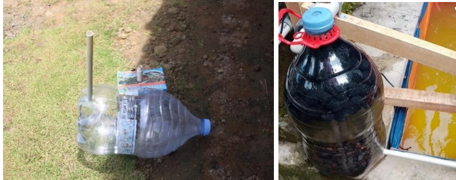
Gambar 9. Filter air pada kolam
