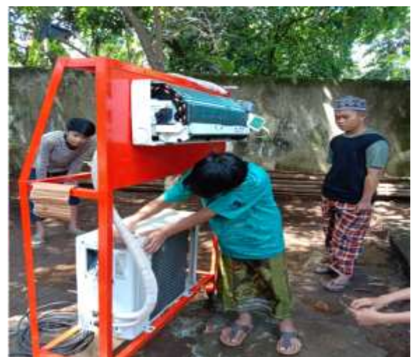
Gambar 4. Melatih dan mendampingi mitra melakukan perawatan bagian outdoor AC
