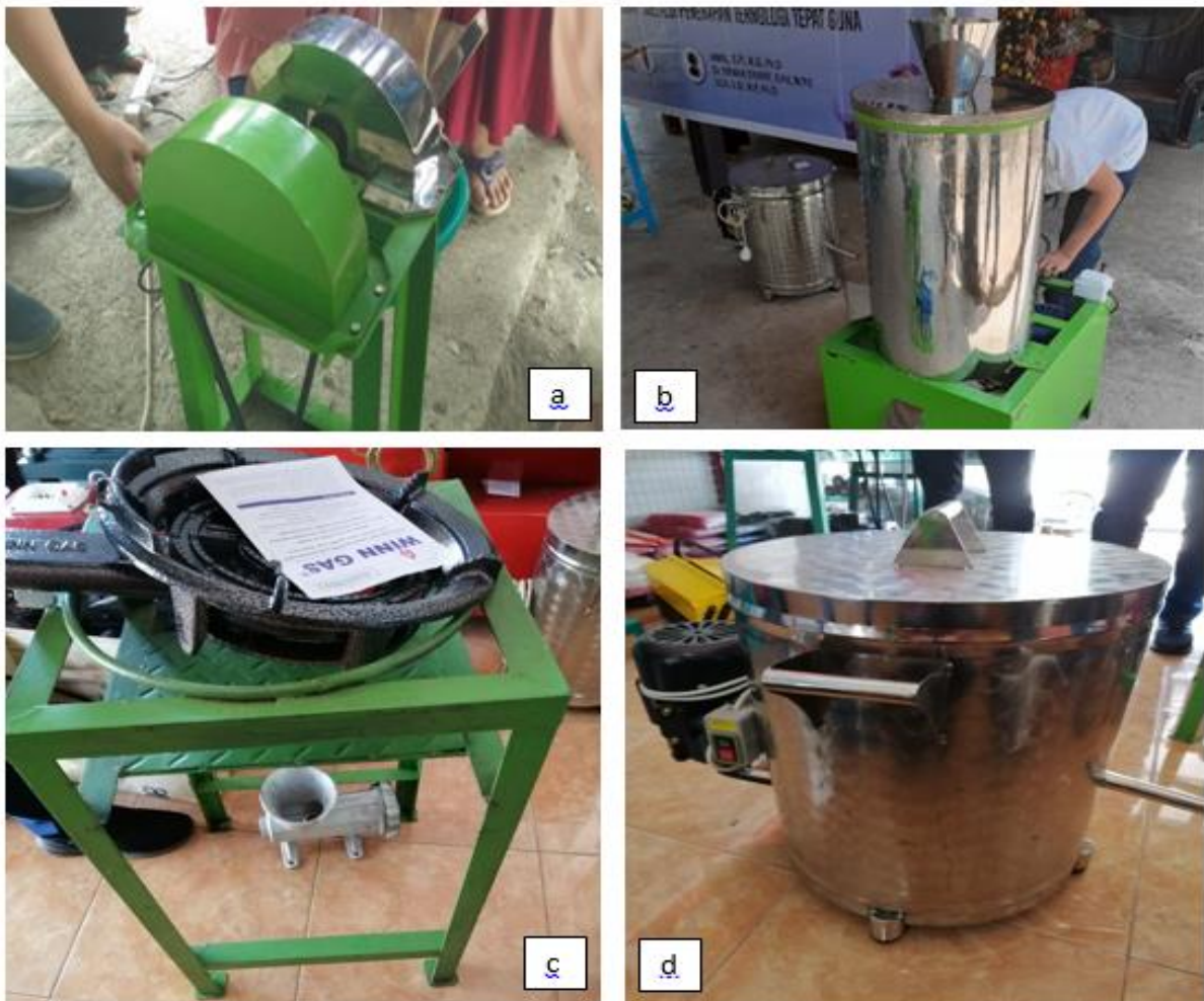
Gambar 1. (a) pengiris bawang, (b) pengupas bawang, (c) penggorengan, (d) spinner
