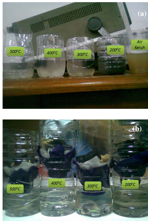
Gambar. 3 Uji penjernihan air menggunakan karbon aktif berbentuk pelet a) tanpa saringan b) dengan saringan
