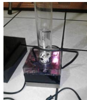
Gambar 2. Filament pemanas pada dasar tabung
