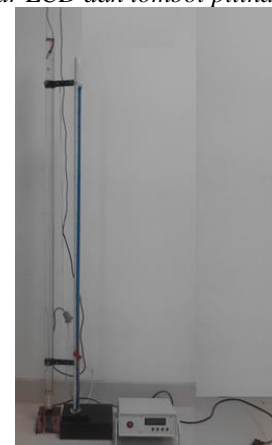
Gambar 4. Alat praktikum viskometer berbasis Sensor Efek Hall UGN3503
