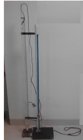
Gambar 1. Tabung Viskositas dan pengukur ketinggian
