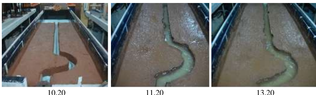
Gambar 12. Percobaan Laboratorium; Komposisi tanah 65%; Silt 27%;Clay 8 % (Sandy Silt)
