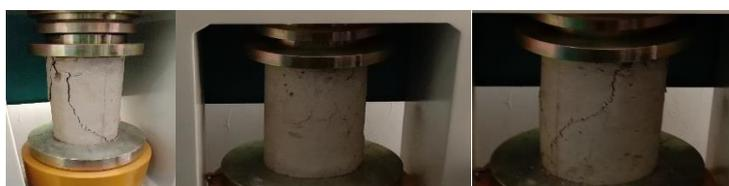
Gambar 2: Bentuk Kehancuran Beton Normal
