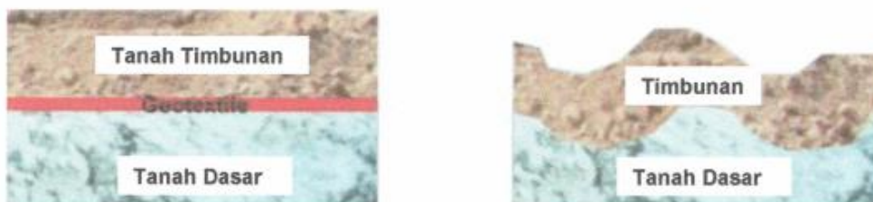
Gambar 2.6 Perbandingan Penggunaan Geotextile dan Tanpa Geotextile
