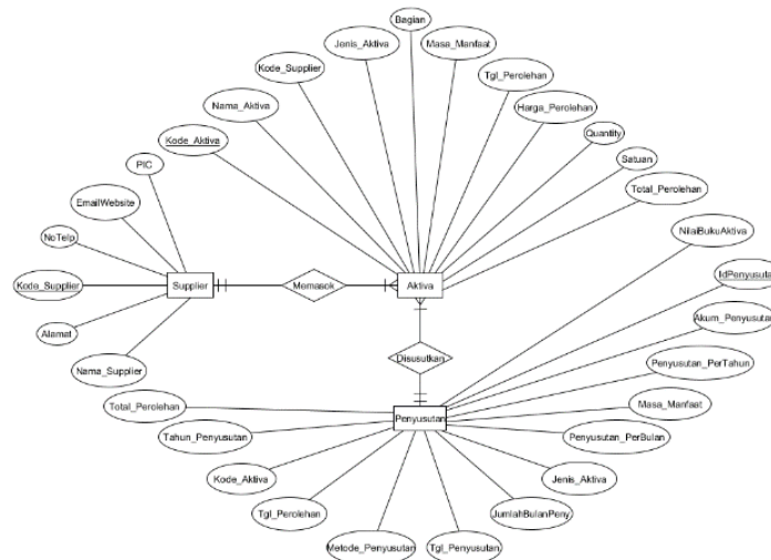
Gambar 4. Rancangan database dengan menggunakan Entity Relationship Diagram (ERD)
