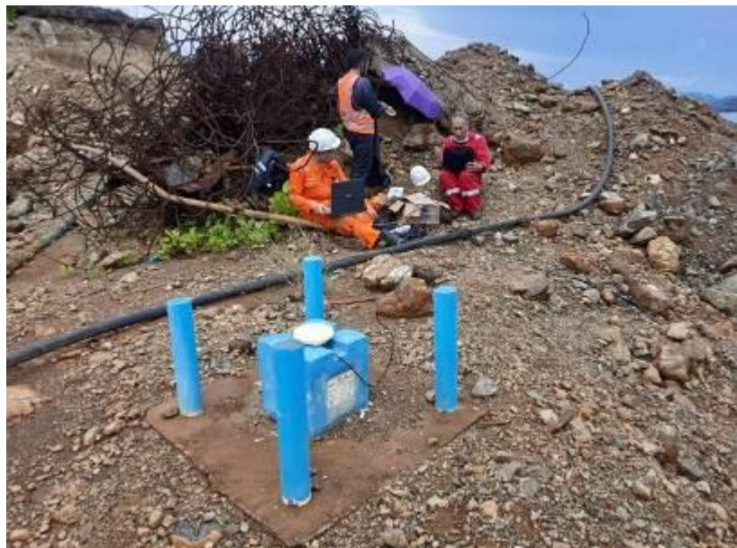
Gambar 1. Verifikasi GPS ke BM (Bench Mark)
