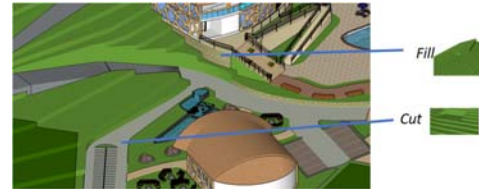
Gambar 18. Cut and Fill pada Site Sumber: Dokumentasi Penulis
