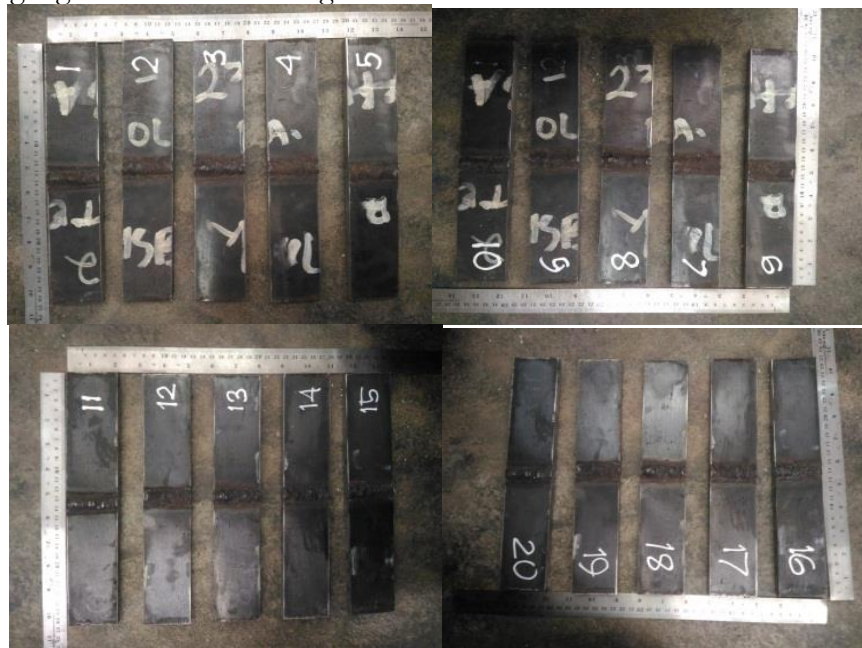
Gambar 6 Spesimen potongan hasil pengelasan sesuai standar ISO 5173
