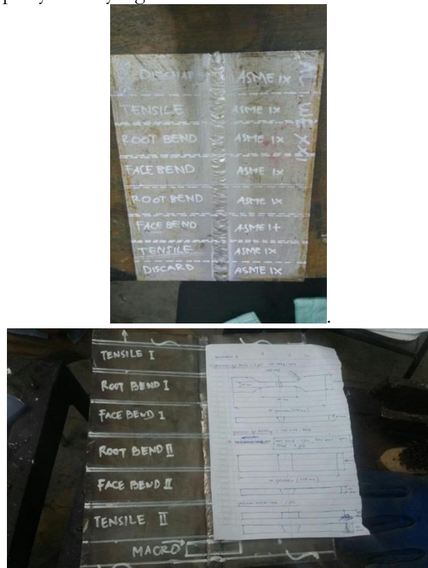
Gambar 5 Pembuatan Spesimen untuk Bending Test
