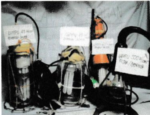
Gambar 1. Underwater lamp jenis E-CDL( 25 W, 35 W dan 45 W) dan Pijar 500 W/220 V
