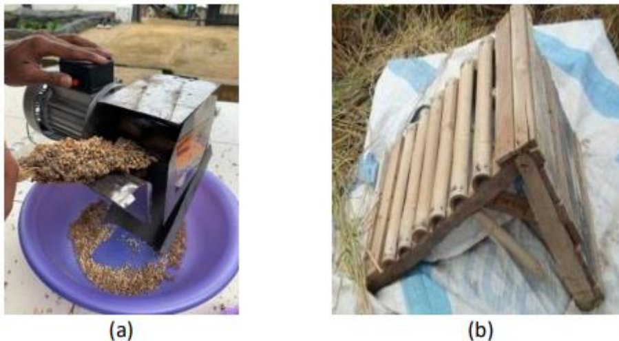
Gambar 4 (a) Proses perontokan menggunakan alat perontok sorgum (b) proses perontokan tradisional
